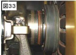
**注意** ※ 日産スカイライン (R32・R33GT-R、ER34) 及び、スバル インプレッサ (GC8、GDB、GRB) は P. 6「1-2 純正レリーズベアリングの取外し」を参考にして、レリーズベアリングの連結解除を行い、レリーズフォークを引抜いた後にトランスミッションの取外しを行ってください。
